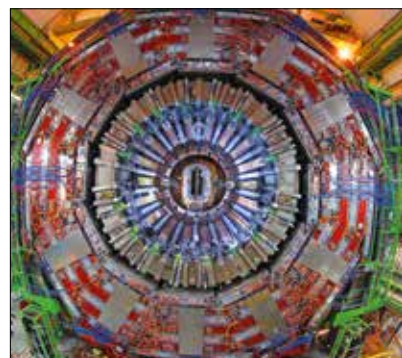
CMS-Detektor am CERN: Länge: 21 m Höhe: 15 m, Masse: 14.000 Tonnen
